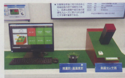
災害対策へのIoT活用事例 災害立国と呼ばれる日本において、降雨による地滑り発生の前兆現象を観測するため、広範囲の計測ポイントに配置した杭と一体型のセンサーからIoT技術でデータを収集。地滑りの危険予知と迅速な避難指示に活かすことが期待される。
