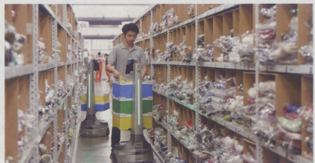
棚の前で待つAMRに、作業者が商品をピッキングして積み込む。作業者は棚のレイアウトを熟知することなくピッキング作業が可能であり、教育コスト削減も見込める。
