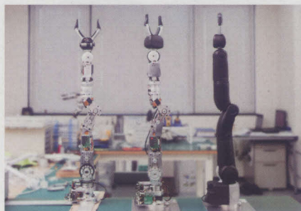
ロボットアームは6つの関節を持つ軽合金製腕部とグripper部から成る。電動車椅子上での使用を想定し、電源は電動車椅子のバッテリーを利用する。
